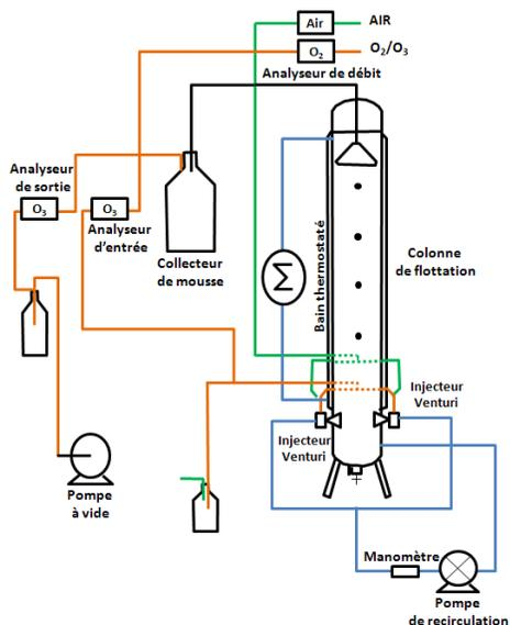
Figure 2 : Synoptique simplifié du procédé pilote (Air, O<sub>2</sub>/O<sub>3</sub>) [2009, Beneventi]
