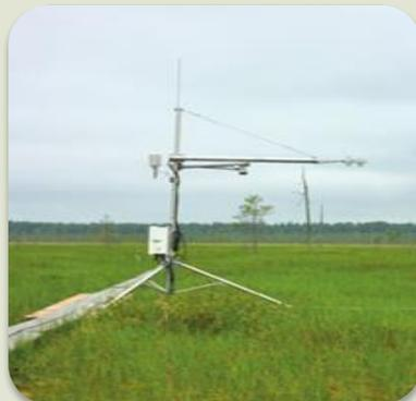
La méthode à la chambre et la covariance des remous ou «tour des flux» sont utilisées pour la mesure directe des émissions de CO<sub>2</sub>, CH<sub>4</sub>, et N<sub>2</sub>O.
