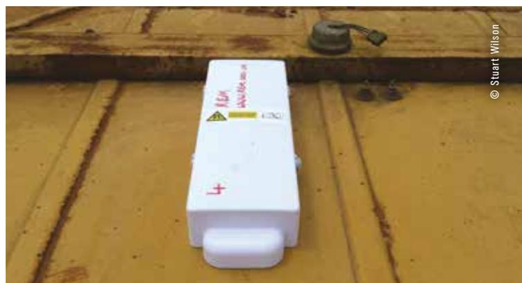
Photo 14 Boîtier GPS fixé sur le toit d'un engin
